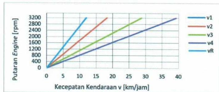
Gambar 4. Kurva kecepatan kendaraan vs putaran engine
